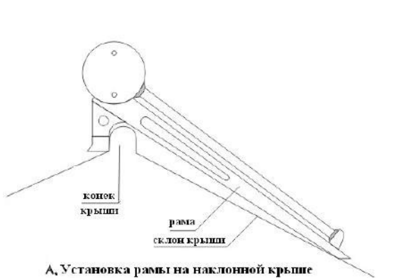
А. Установка рамы на наклонной крыше
