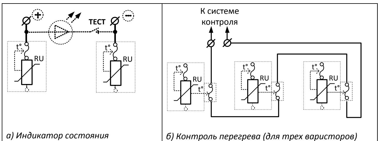
Рисунок 3. Функциональные схемы систем контроля состояния УЗФЭС
