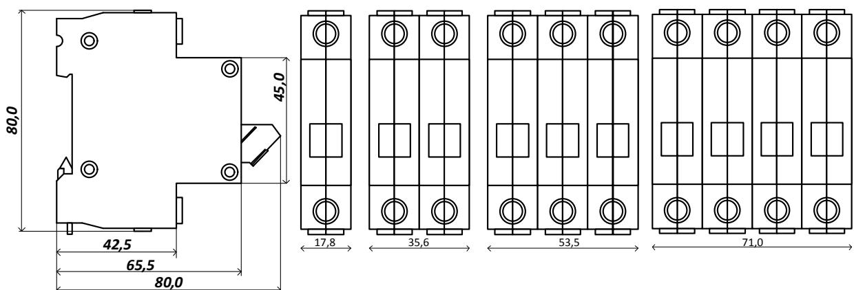
Рисунок 4. Габаритные размеры (1-4 U) УЗФЭС классов 3 и 2, УЗФЭС-Д
