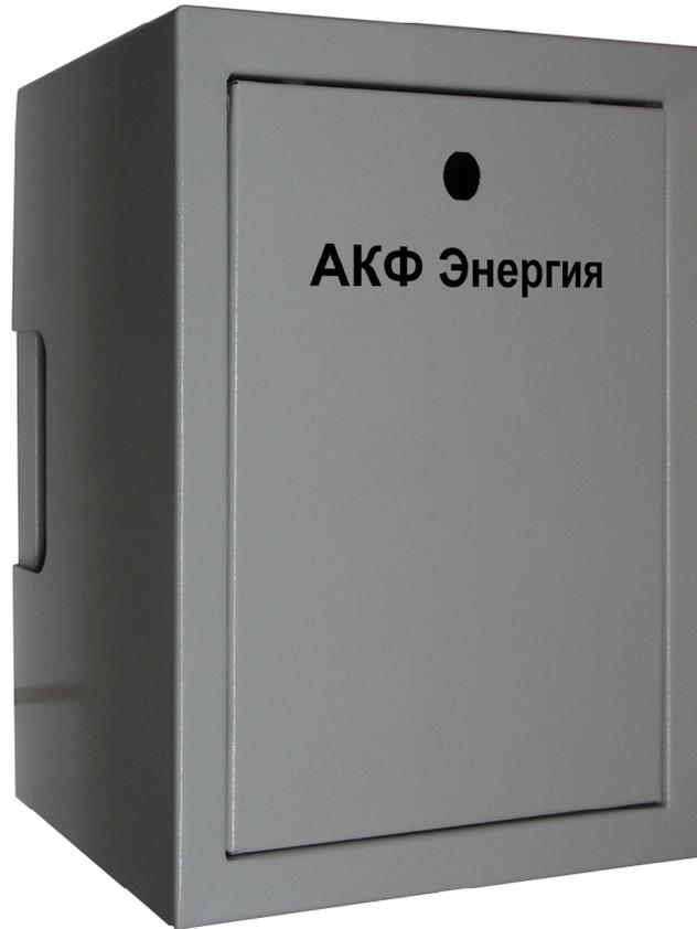
Устройство предназначено для автоматического резервирования 3-х линий (фаз) одним преобразователем (инвертором) МАП SIN «Энергия» Pro, при условии отсутствия 3-х фазных потребителей. Если таковые имеются (трёхфазные двигатели и т.п.), то их надо подключить до системы резервирования.
