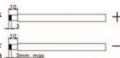
**Шаг 4:** Проверьте правильность полярности подключения кабеля от ФЭ модулей и коннекторов для подключения солнечной батареи на инверторе. Затем соедините положительный полюс (+) соединительного кабеля фотоэлектрических модулей с положительным полюсом (+) входного коннектора инвертора. Соедините отрицательный полюс (-) соединительного кабеля фотоэлектрических модулей с отрицательным полюсом (-) входного коннектора инвертора.
